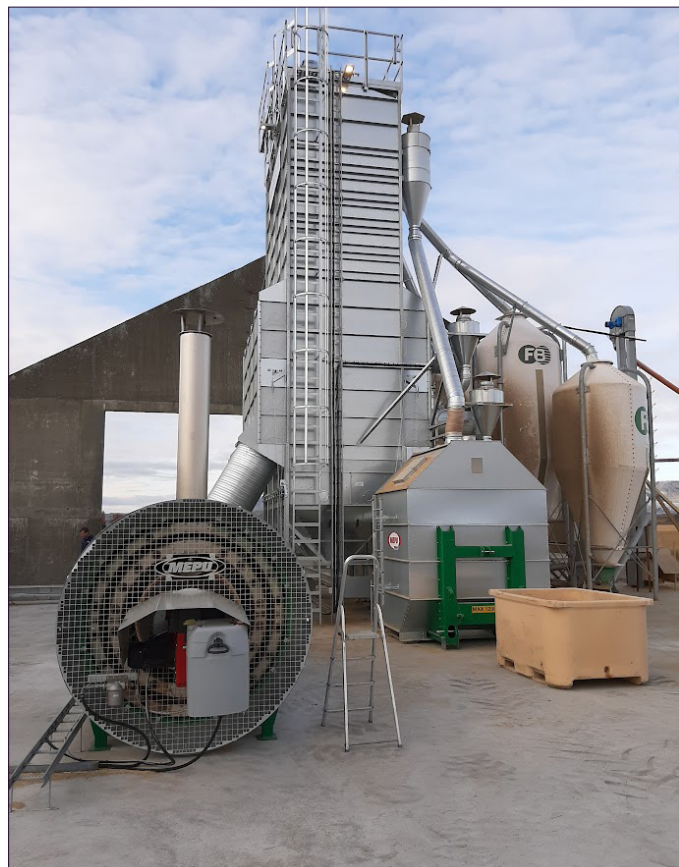
Mynd 11-4. 47 m 3 staðbundin lotuþurrkari á Flatey á Mýrum. Þurrkarinn er kynntur með 1MW varmaskiptum olíuhitara og er búin ryksöfnunarkerfi.
