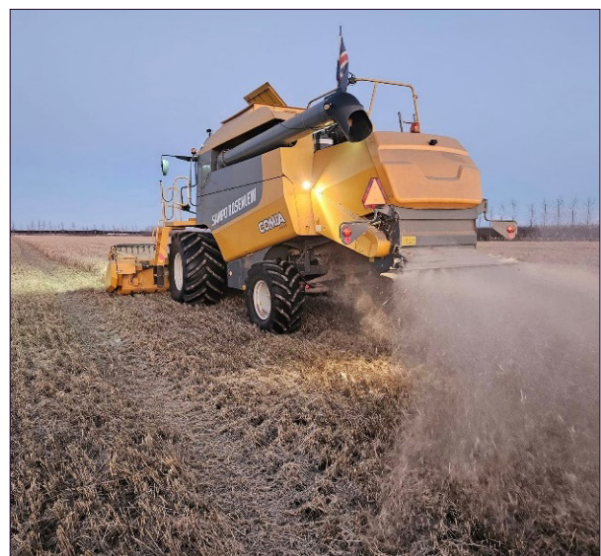
Mynd 10-11. Hálmur saxaður í þreskivél og dreift yfir nýskorinn kornakur í Gunnarsholti. Mynd: Björgvin Þór Harðarson.
