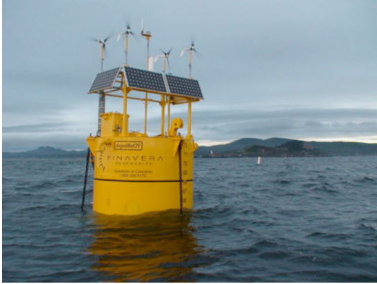
Mynd 4: Tilraunaölduvirkjunin Aquabuoy frá kanadíska fyrirtækinu Finavera Renewables.
