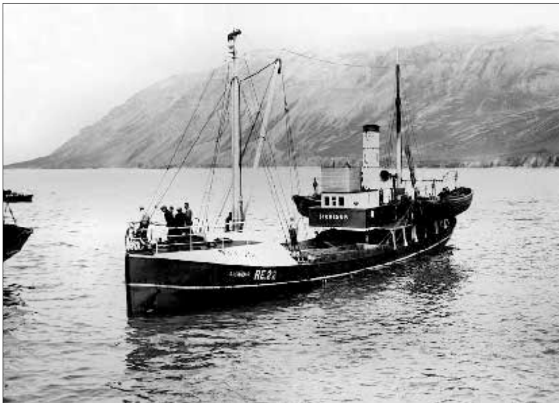
Línuveiðarinn Sigríður kemur að landi á Siglufirði. Línuveiðararnir voru mikið notaðir til síldveiða á millistríðsárunum. Þessi er með tvo nótabáta í dæðum, og á þaki stýrishússins er skýli nótabassans. Ljós.: Steingrímur Kristjánsson
