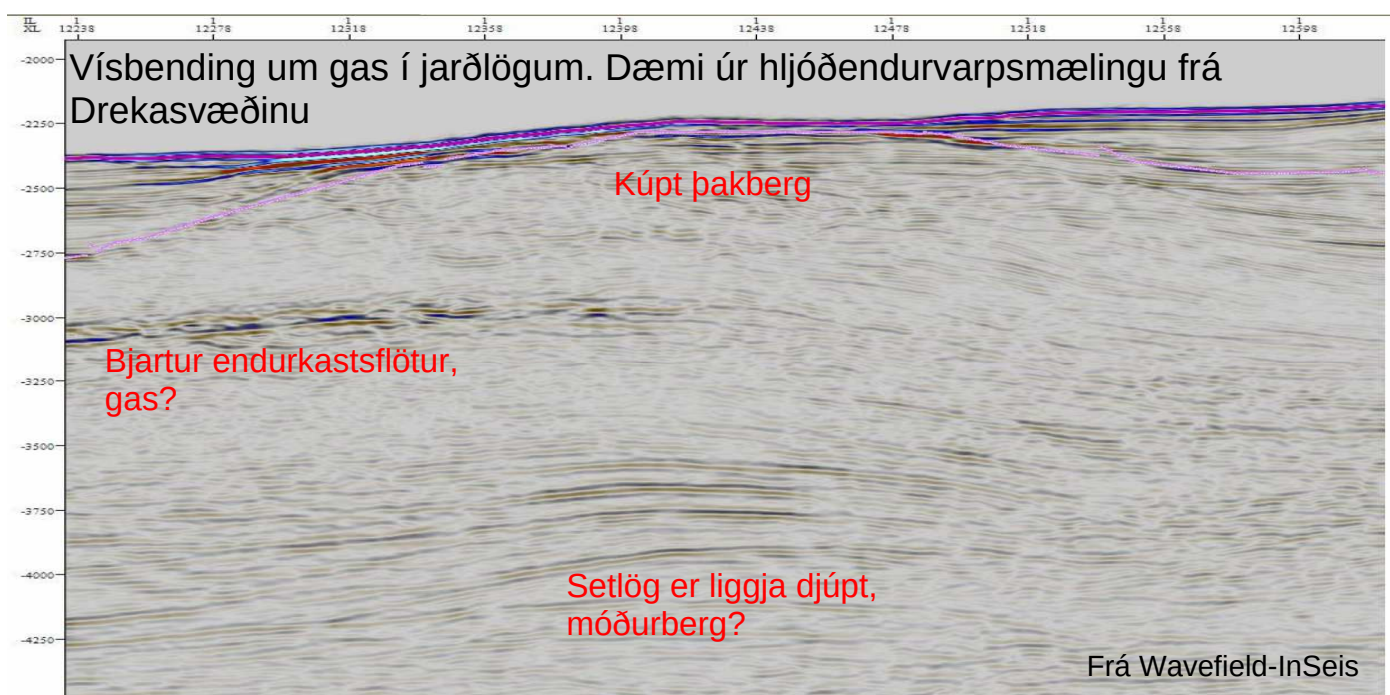
Mynd 7. Þversnið gegnum mögulega gas- og/eða olúgildru á norðanverðu Drekasvæðinu. Dæmið er úr mælingum InSeis frá 2001. Birt með leyfi Wavefield-InSeis.
