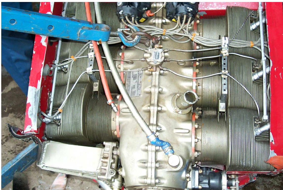
Myndin sýnir hreyfil flugvélarinnar. Olíukælirinn er vinstra megin á myndinni fyrir framan strokk nr. 5 og staðfestir það að hreyfillinn er H-gerð
