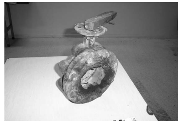
Mynd 2. Spjaldloki og flangs ryðbrunninn frá röri, snéri niður
