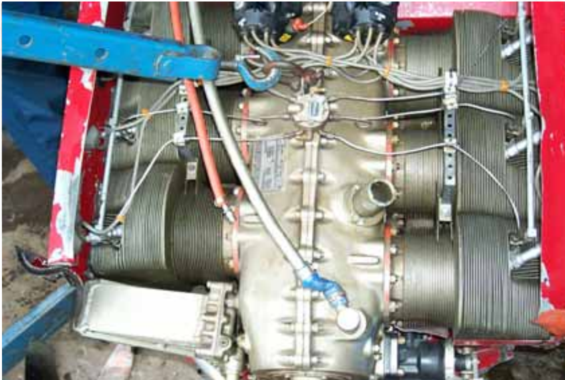
Myndin sýnir hreyfil flugvélarinnar. Oliukælirinn er vinstra megin á myndinni fyrir framan strokk nr. 5 og staðfestir það að hreyfillinn er H-gerð
