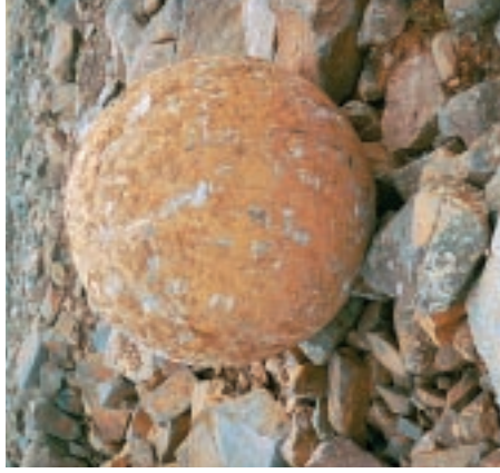
Mynd 8.8: Stálkúla sem notuð er til að brjóta stórgrjóti í nýtanlegar stærðir.
